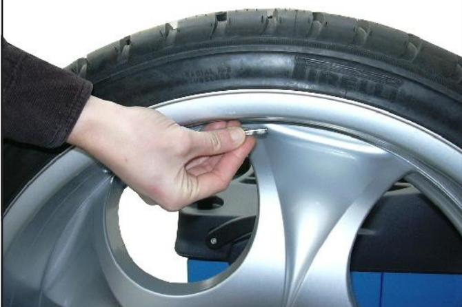
Um das Klebegewicht auf der Radinnenseite anzubringen, drehen Sie das Rad so lange in der Richtung der Pfeile (die waagerechte Pfeile), bis Sie die richtige Stellung erreichen. Bringen Sie das Klebegewicht auf der inneren Radseite an. Setzen Sie das Gewicht der Außenseite **von Hand oben auf die Senkrechte, auf 12 Uhr** (Abb. 54), das Gewicht soll dem erfassten Wert entsprechen (das Beispiel der Abb. 53 gibt 35 g an).
