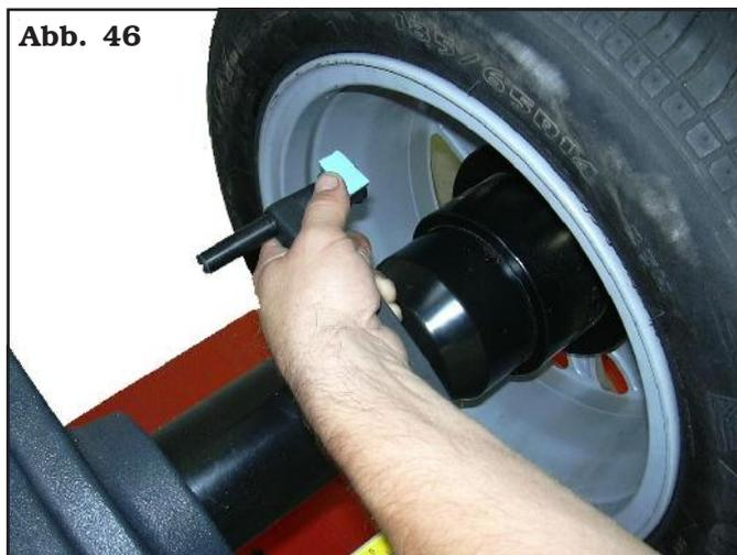
Lesen Sie das Abstandsmaß auf dem manuellen Abstandstaster ab. Bringen Sie das Klebegewicht auf der Radaußenseite an (**Abb. 47**). Halten Sie sich an den angegebenen Abstand (175 mm im Beispiel) und verwenden Sie ein Gewicht, das dem erfassten Wert entspricht (das Beispiel zeigt 30 g). Die Position des Außengewichtes ist nicht ersichtlich, aber intern verborgen.
