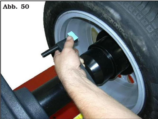
Lesen Sie das äußere Abstandsmaß auf dem manuellen Abstandstaster ab. Bringen Sie das Klebegewicht auf der Radaußenseite an (**Abb. 51**). Halten Sie sich an den angegebenen Abstand (210 mm im Beispiel) und verwenden Sie ein Gewicht, das dem erfassten Wert entspricht (das Beispiel 30 g). Die Position des Außengewichtes ist nicht ersichtlich, aber intern verborgen. Drehen Sie das Rad, bis Sie die richtige Stelle erreichen (Abs. 14.3.2).
