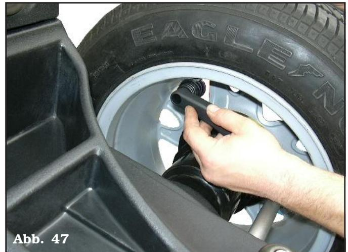
Führen Sie einen Kontrolllauf aus, um den Auswuchtzustand des Rads zu überprüfen. Das Display muss die Nullstellung der Unwucht anzeigen. Die STATIC Prozedur ist nun komplett ausgeführt.
